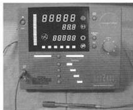
FIGURA 4 Equipo manual de detección de partículas (consola y sonda)
